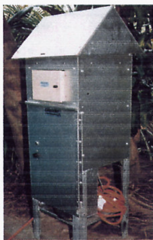
Figura 2. Medidor de Alto Volumen utilizado en la medición de partículas totales en suspensión.
